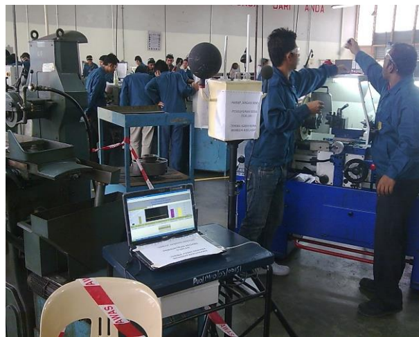
Rajah 3. Kedudukan alat Thermal Comfort Multistation (TCM) sewaktu bacaan diambil.
