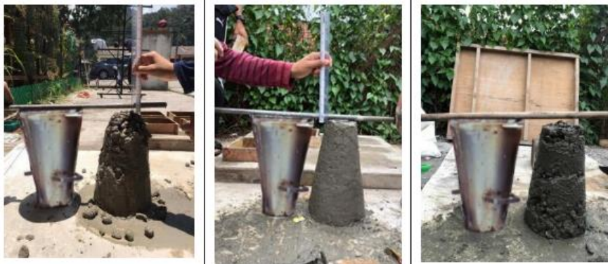
Rajah 4. Ujikaji Penurunan Konkrit mengikut nisbah bancuhan 0%, 5% dan 10%
